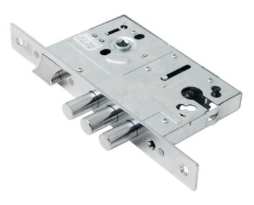
Врезной сувальдный замок с тремя ригелями. Предназначен для установки во входные и технические металлические двери.
