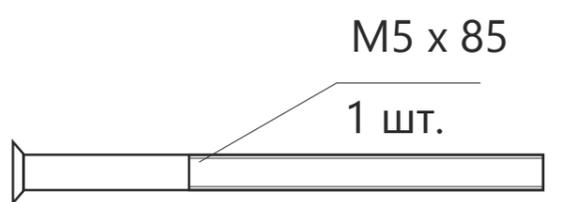
Винт крепления цилиндра
