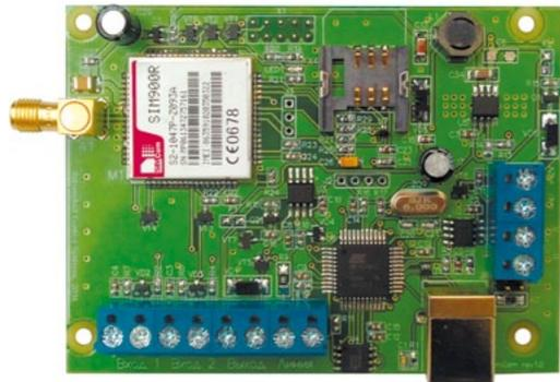
*Плата расширения GSM превращает замок в полноценную систему контроля доступа и охранной сигнализации.*
