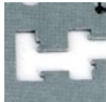
Ложные пазы на сувальдах и П-образная стойка хвостовика — защита от вскрытия отмычками.
